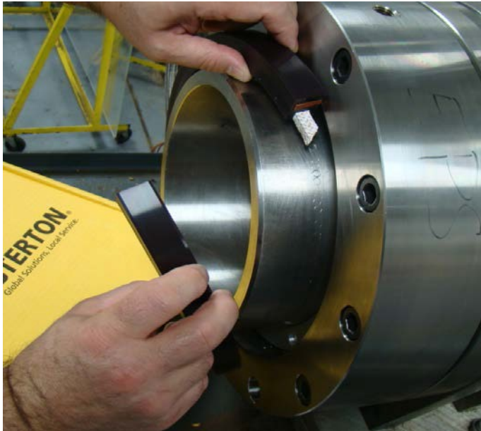
Steg 1: Håll i ändarna, vrid upp och kräng sedan tätningen över axeln.
