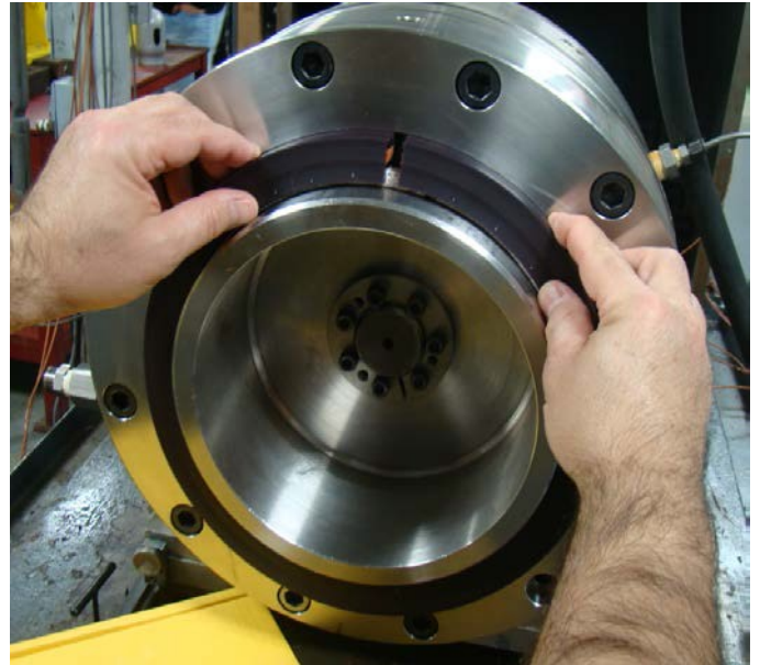
Steg 2: För ihop ändarna och positionera delningen klockan 12.
