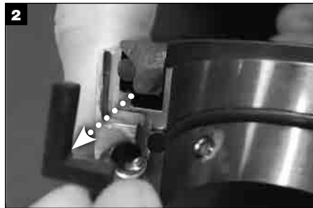
2 Avlägsna de förbrukade packningarna från den roterande hållaren.
