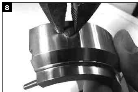
8 Avlägsna de förbrukade centreringsknapparna från den roterande hållarens utsida.
