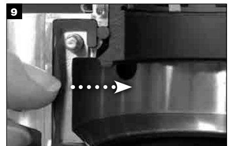
9 Avlägsna förbrukade glandpackningar från spårerna i glanden.
