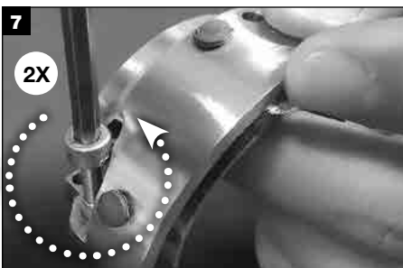
7 Avlägsna de förbrukade insexskruvarna från hållarens halvor.
