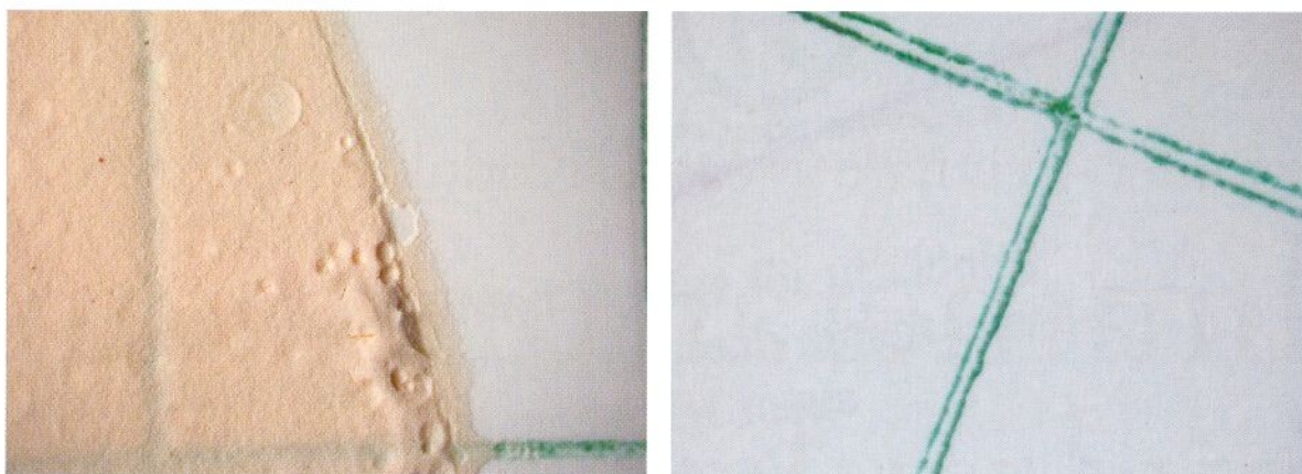
Filtermembran från gravimetrisk analys av olja från Stora Enso Hyltes softkalander. Proven är tagna på olja representativ för den som är i tanken just före inmonteringen av Europafiltren (bilden till vänster), samt efter att de har varit i drift ungefär ett år (bilden till höger). Att mängden oxidationspartiklar minskat radikalt syns klart när man jämför de båda proven. Föroreningsnivån hade minskat från 3,9 till 0,6 mg/100 ml.
